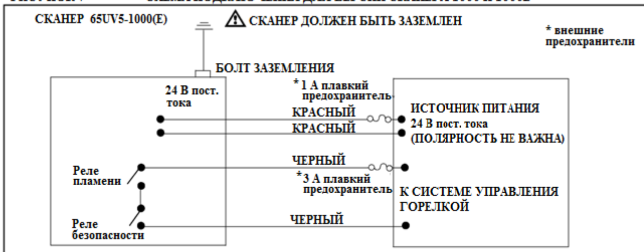
РИСУНОК 8 СХЕМА ПОДКЛЮЧЕНИЯ ДЛЯ ВЕРСИЙ СКАНЕРА 1004 И 1004E
