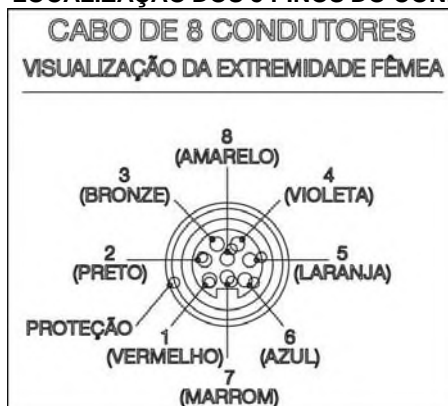
FIGURA 7. LOCALIZAÇÃO DOS 8 PINOS DO CONECTOR DO CABO 59-546-X
