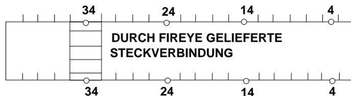
Von der Rückseite aus gesehen (für das VOLLRACK), können die Steckverbindungen an den Positionen 6, 16, 26, 36, 46, 56 und 66 in das Rack geschraubt werden. Eine durch Fireye gelieferte Steckverbindung wurde bereits in Rackposition 76 geschraubt.
