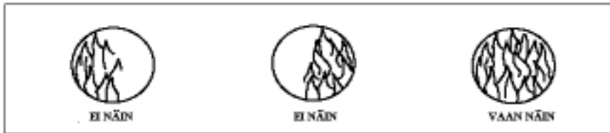
KUVA 6. TARKKAILUPÄÄLLÄ OLTAVA ESTEETÖN NÄKÖALA LIEKKIIN
